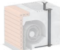
Stahlbefestigungskonsole Zur Fenster- befestigung an der Betondecke (z. B. bei bo- dentiefen Elementen) bzw. als Aufhängung bei fehlendem Auflager (z. B. Eckelement)
