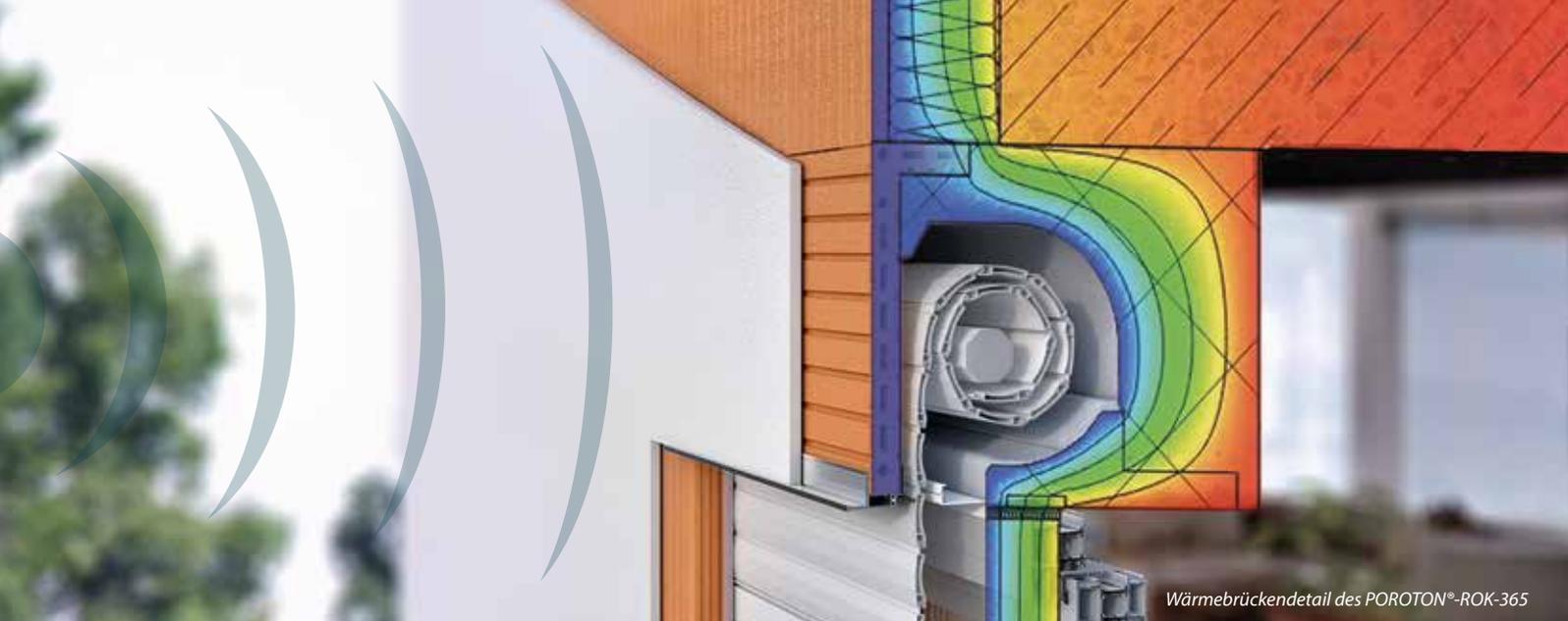
Wärmebrückendetail des POROTON®-ROK-365
