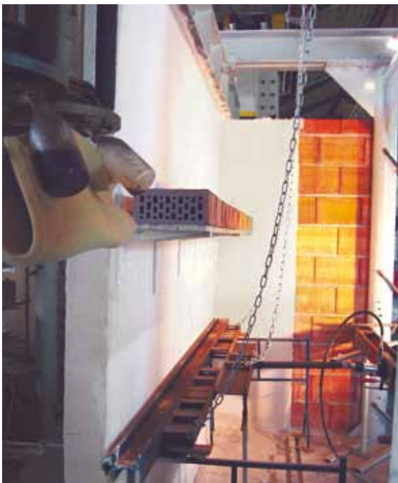
Biegegrenztragfähigkeitsversuch nach DIN 4103 an einer verputzten Zwischenwand (Hochlochziegel-Plan T0,8-115)
