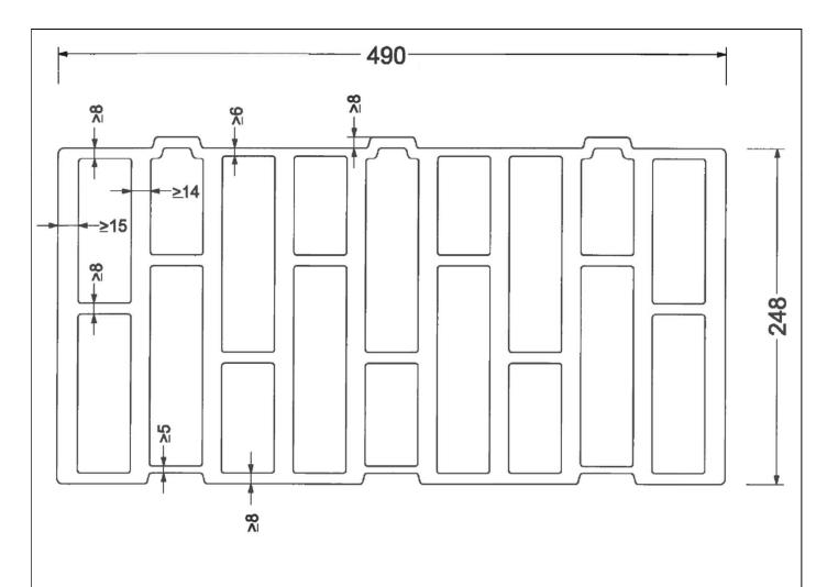
Mauerwerk aus Planhochlochziegeln mit integrierter Wärmedämmung - bezeichnet als POROTON-T9-A-Planziegel - im Dünnbettverfahren
