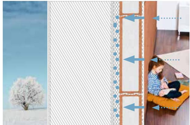
Warme Luft ist feuchter als kalte Luft. Durch diese Temperaturdifferenz zwischen innen und außen kommt es zu Dampfdruckdifferenzen. Wasserdampf gelangt in die Wandkonstruktion.
