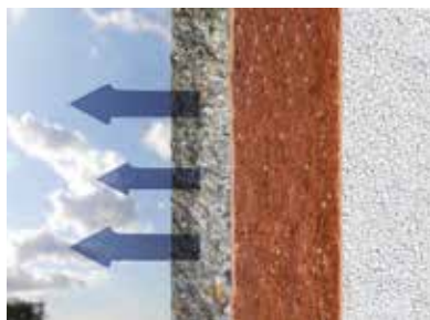
Bei sinkender Luftfeuchtigkeit wird die Feuchtigkeit sofort wieder an die Atmosphäre abgegeben. Die Fassade trocknet deutlich schneller und bietet Algen und Pilzen keinen Nährboden.
