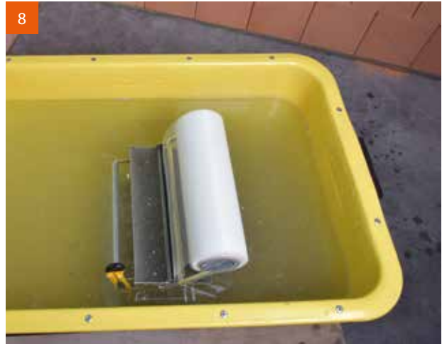
8 In längeren Pausen empfiehlt es sich, die V.Plus®-Walze im Wasserbad zu lagern, um ein Austrocknen des Mörtels zu verhindern.
