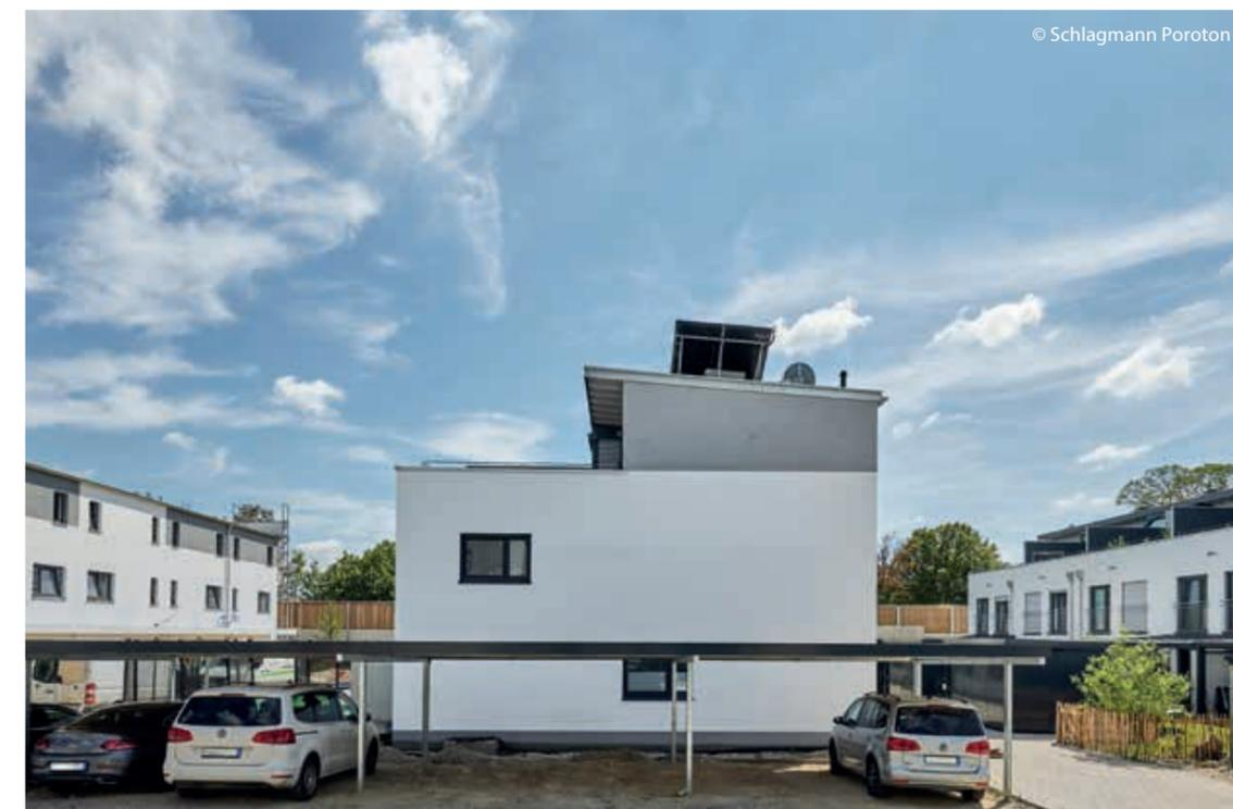
Im Erdinger Thermengarten konnte Redbloc in vielerlei Hinsicht punkten: Mit diesen vorgefertigten Ziegelwänden kann man einen Rohbau deutlich schneller erstellen und braucht deutlich weniger Personal auf der Baustelle. Am Ende hat man trotzdem alle Vorteile eines hochwertigen monolithischen Ziegel-Gebäudes. Im Thermengarten wurde Beton nur dort verwendet, wo es nicht anders ging: im Bereich des Kellers sowie dort, wo es die Statik erforderte, beispielsweise an den Brüstungen der Dachterrassen.
