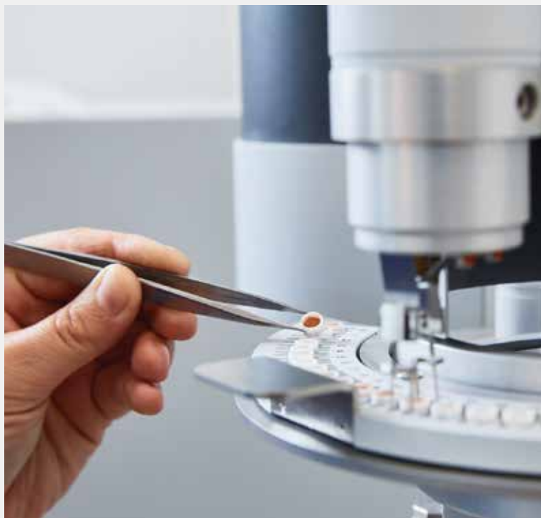
Bild Mitte: hier werden thermo- analytische Prüfungen an Rohstoff-Mischungen vorgenommen.
