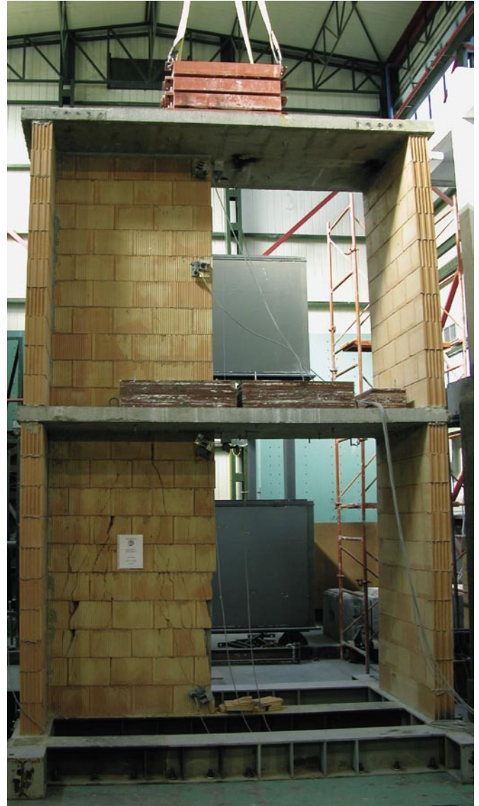
Bild 6: Prüfkörper mit Schubwänden aus Hochlochziegeln und Füllziegeln
